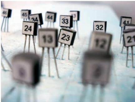
Bild 1: Geringstmögliches Rauschen durch selektierte Feldeffekttransistoren
