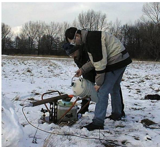
Bild 15: Hochtemperatursupraleiter-SQUID-Messsystem, das in Kooperation mit der TU Berlin im Rahmen eines Drittmittelvorhabens für geophysikalische Messungen entwickelt wurde. Das System diente dem Test eines sog. Radiomagnetischen Sondierungsverfahrens zur Vermessung der Bodenleitfähigkeit in Tiefen von bis zu einigen zehn Metern. Das Bild zeigt die Mitarbeiter beim Auffüllen von flüssigem Stickstoff bei Feldmessungen.
