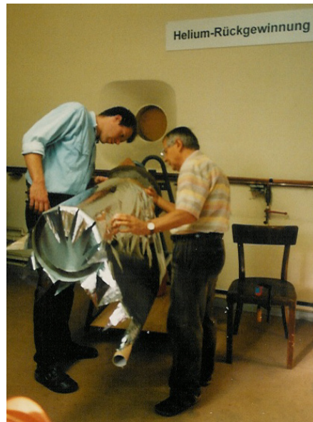
Bild 6: Herstellung von magnetisch rauscharmen Kryostaten. Das Bild zeigt Götz Klaukin und Klaus-Peter Matthies im Jahre 1995 beim Wickeln der Superisoliationsfolien auf einen Kryostateninnenbehälter.
