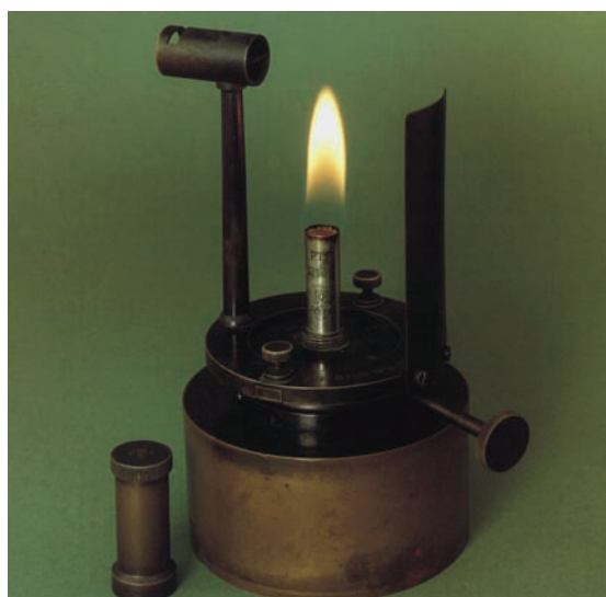
Bild 1: Historisches Strahlungsnormalsystem mit einer brennenden Hefner-Lampe für die Darstellung der Lichteinheit. „Speist man diese Lampe mit Amylacetat (von C. A. F. Kahlbaum in Berlin) und macht die Flamme gleich 40 mm, so erhält man das deutsche „Normallicht“, ein „Hefnerlicht“ oder eine „Hefnerkerze (HK)“ (Journal für Gas- und Wasserfach, 1889) [3].
