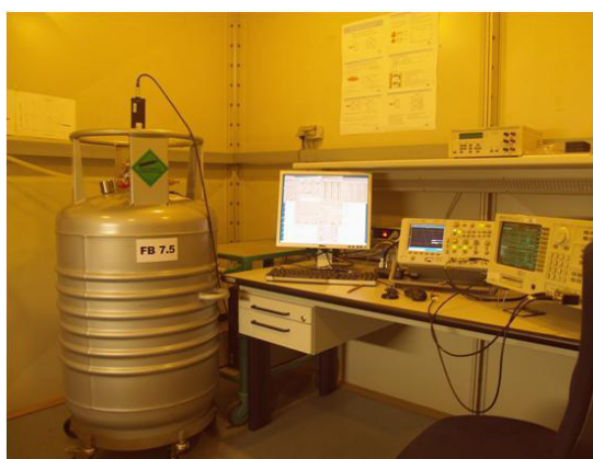
Bild 5: Messplatz mit Heliumkanne zur Charakterisierung von SQUIDs in geschirmter Kabine
