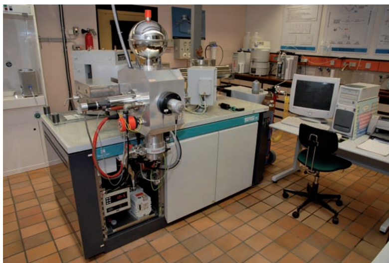
Bild 6: Massenspektrometer mit thermischer Ionenquelle, das in der PTB hauptsächlich zur Messung der Häufigkeitsverhältnisse von Isotopen und damit auch zur Elementanalytik mit der Isotopenverdünnungs-Massenspektrometrie (IDMS) eingesetzt wird.
