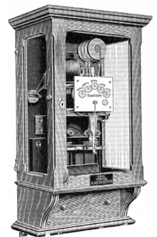
Bild 6: Herrmann Aron (1845–1913) und der von ihm und seinen Ingenieuren entwickelte Doppel-pendelzähler. Dieser Gerätetyp war der erste, der von der PTR eine Bauartzulassung auf der Grundlage des G. e. M. erhielt. Die Veröffentlichung erfolgte 1903 mit der Bekanntmachung Nr. 1 in den PTR-Mitteilungen. Die auch heute noch veröffentlichten Bekanntmachungen von Zulassungen führen inzwischen Nummern im Bereich 5200.
