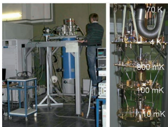
Bild 4: ^3\text{He}/^4\text{He} -Lösungskältemaschine mit Pulsrohrvorkühlung zur Charakterisierung supraleitender Sensorschaltungen im Fachbereich 7.2 „Kryophysik und Spektrometrie“. Links komplette Anlage; rechts geöffneter Kryostat der Anlage mit Kennzeichnung der einzelnen Temperaturstufen
