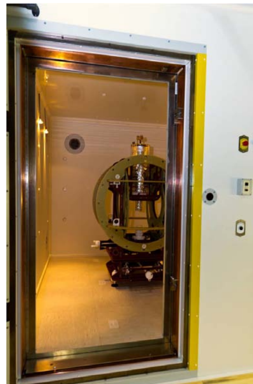
Bild 8: lfNMR-SQUID-Messaufbau der PTB mit Spulensystem in einer magnetisch geschirmten Kabine.
