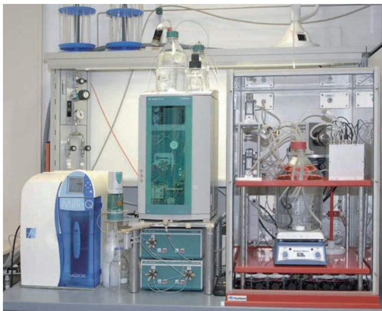
Bild 9: Mess- und Dosierapparatur für Messungen und Kalibrierungen im Bereich sehr geringer elektrischer Leitfähigkeit (5,5 \mu\text{S}/\text{m} bis 15 mS/m)
